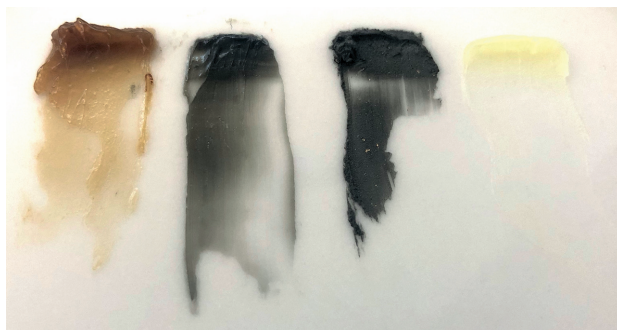
Abb. 6. Fettproben nach 1.200.000 km (v.l.): eine Fettsorte, die wenig Alterung zeigt; eine Probe, die hohe Eisenanteile enthält (Lagerverschleiß); eine Probe mit hohem Messinganteil; Frischfett. In der Abbildung handelt es sich um verschiedene Typen – die Ausgangsfarben sind nicht ident.
